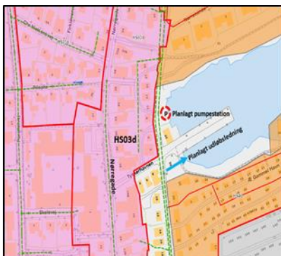
Figur 7: Etablering af pumpestation og udløbsledning i forbindelse med separering af opland HS03d i Hvide Sande.
